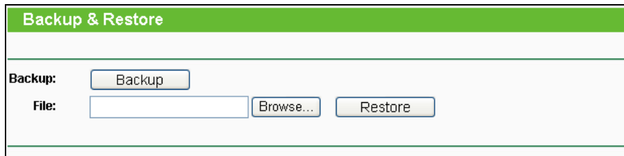
Bild 4-121 Backup &amp; Restore der Routerkonfiguration
